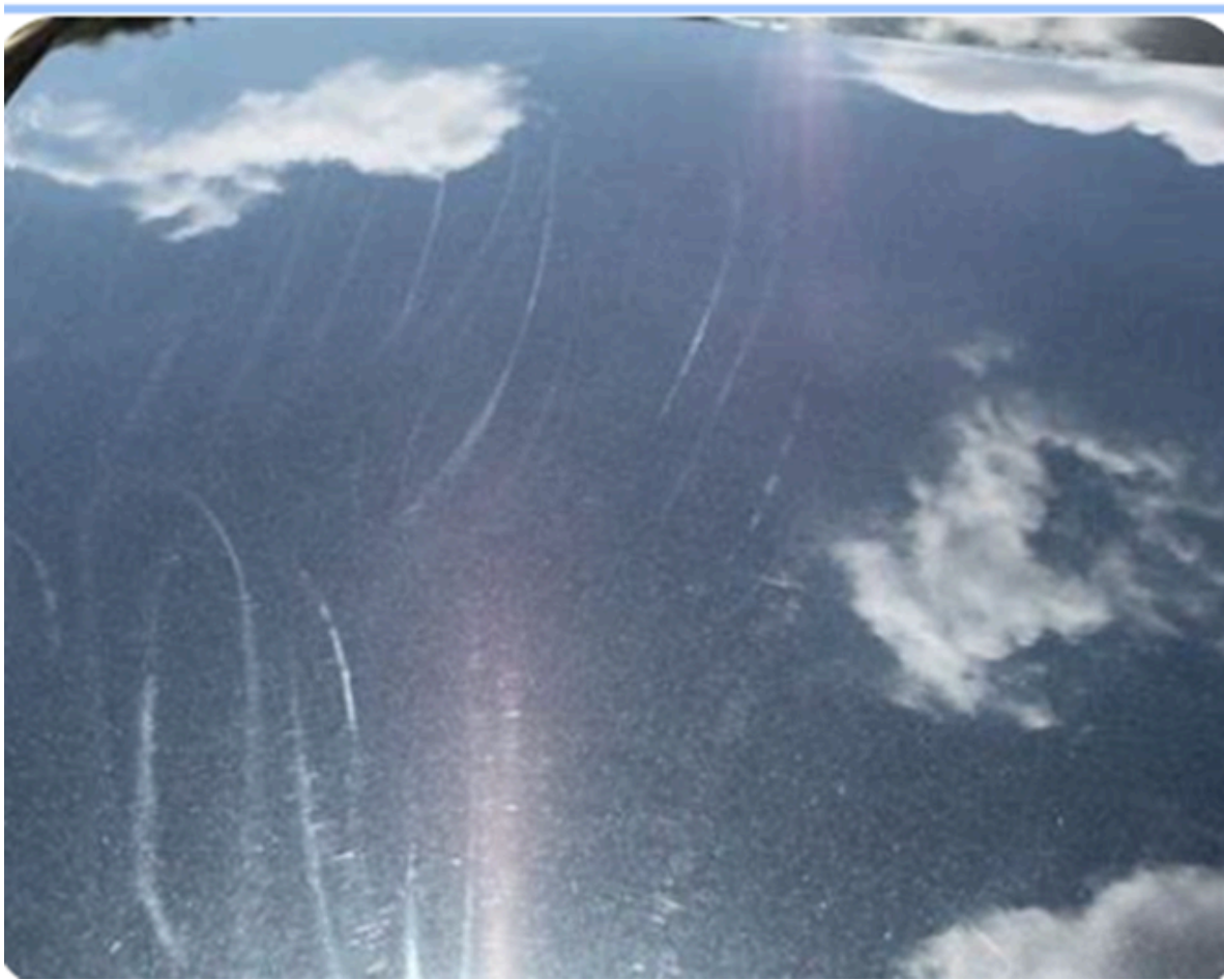
LogH Cで検出されない表面欠陥
